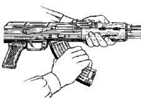
Рис. 19. Присоединение газовой трубки
