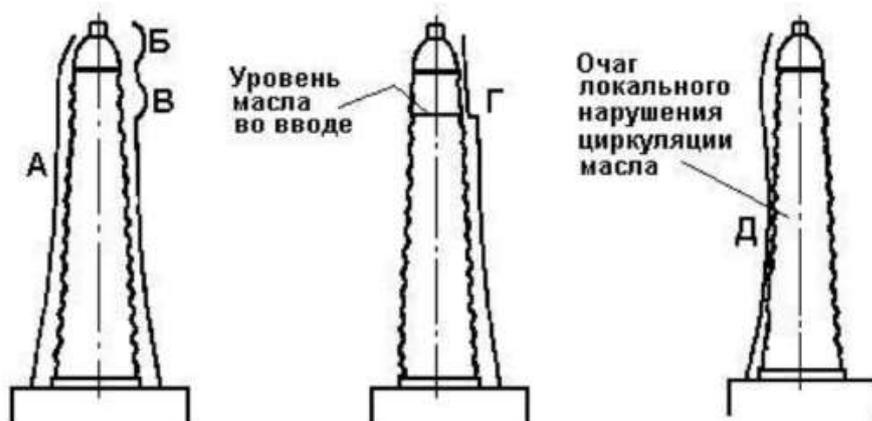
Рисунок 3 - Характер распределения температуры по высоте маслонаполненного ввода.
