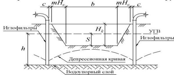
Рис. 6. Схема для расчета иглофильтровой установки
