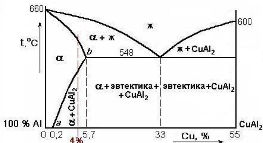
Рисунок 4.1 – Диаграмма состояния алюминий медь
