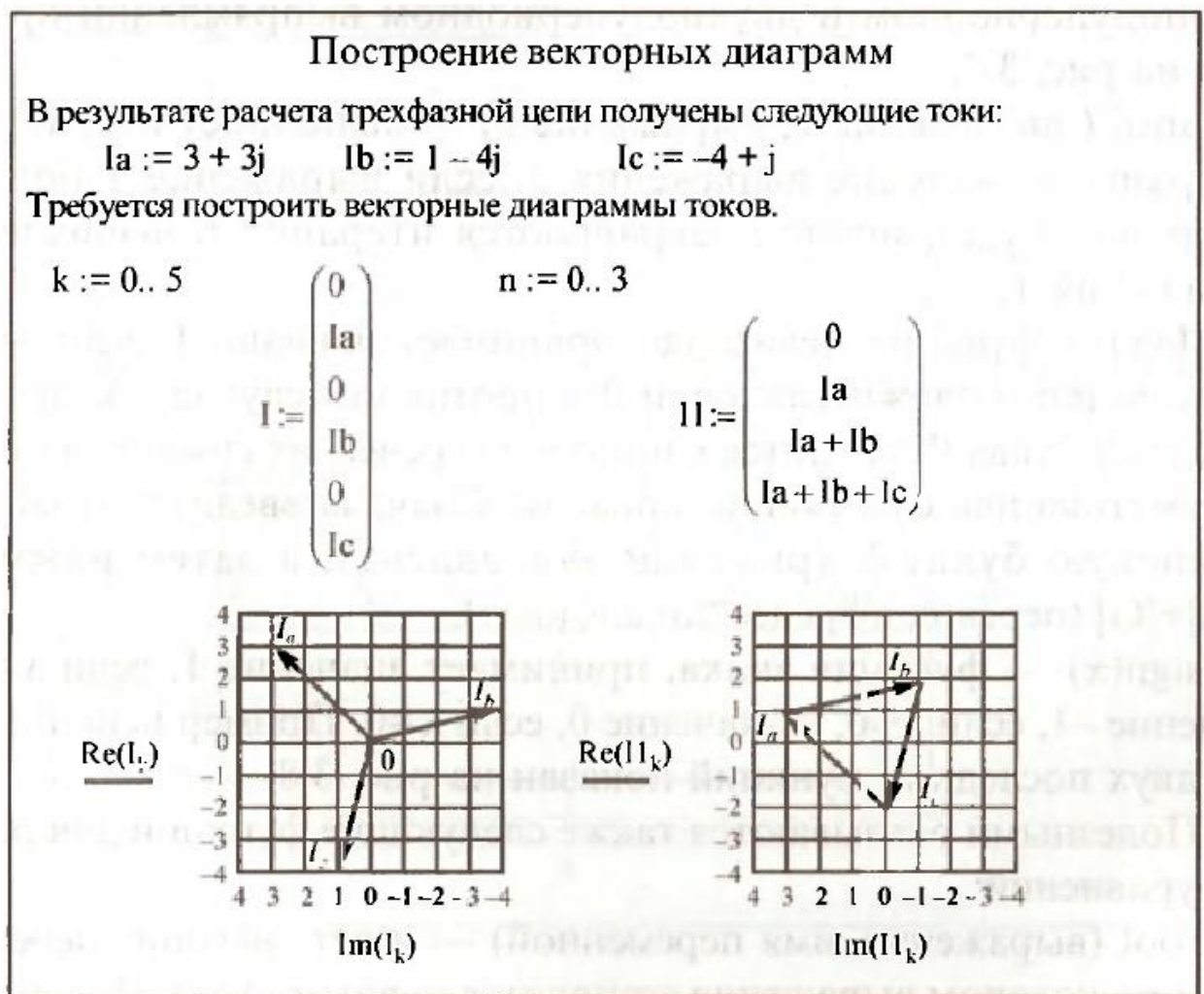
Рис. 3.6. Построение векторных диаграмм для симметричной трехфазной цепи
