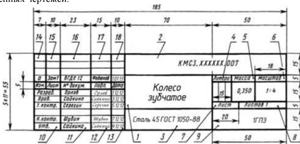
Рисунок 1 Основная надпись чертежа
