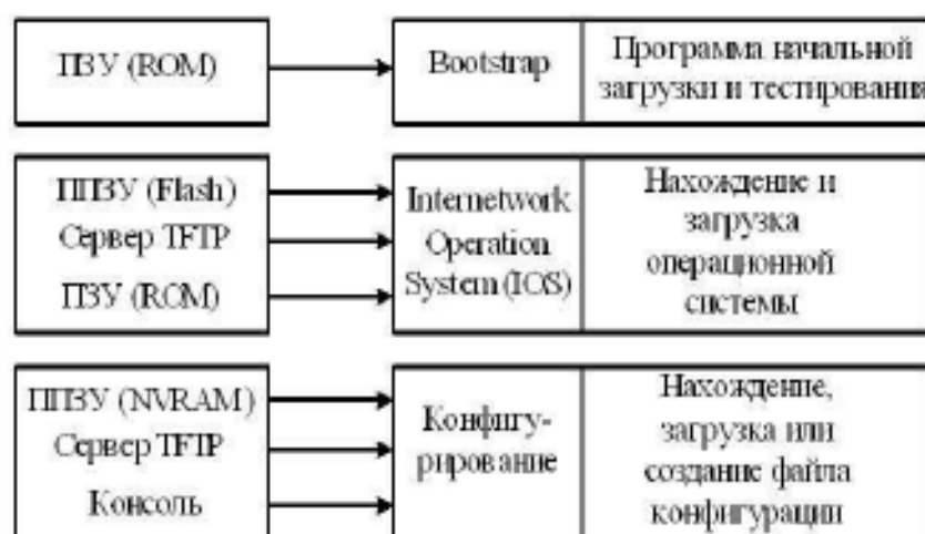
Рисунок 2.4 - Элементы памяти и программы маршрутизатора
