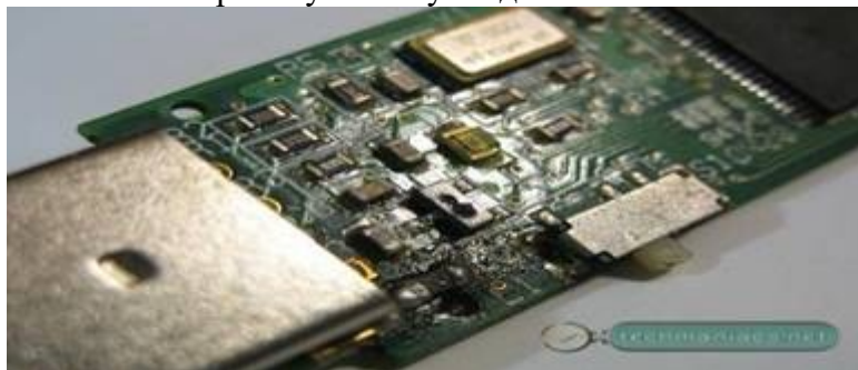
Рисунок 4 - Внешний вид флэш-накопителя со сгоревшим стабилизатором
