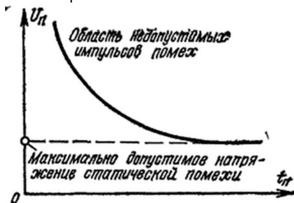
Рис. 2. Характеристика динамической помехоустойчивости логической микросхемы
