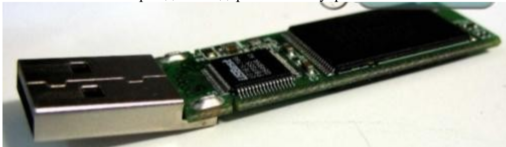
Рисунок 3 - Внешний вид флэш-накопителя со сломанным разъемом
