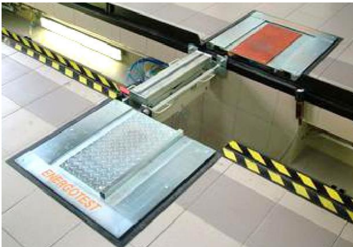
Рисунок 7. Общий вид детектора люфтов в подвеске автомобиля
