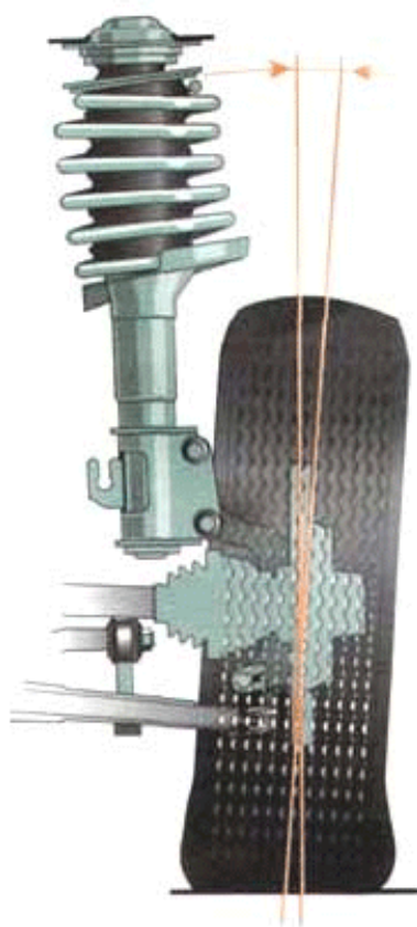
Рис. 2. Угол развала колеса.
