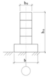
$V_f = l_f \times b_f \times (h_f - h_{\text{под.}}) + l_f \times b \times h_{\text{под.}}, \text{ м}^3$ <p>где <math>l_f</math> – длина фундаментов, м; <math>b_f</math> - ширина фундаментов, м; <math>h_f</math> - высота фундаментов, м; <math>h_{\text{под.}}</math> – высота подушки</p> |
