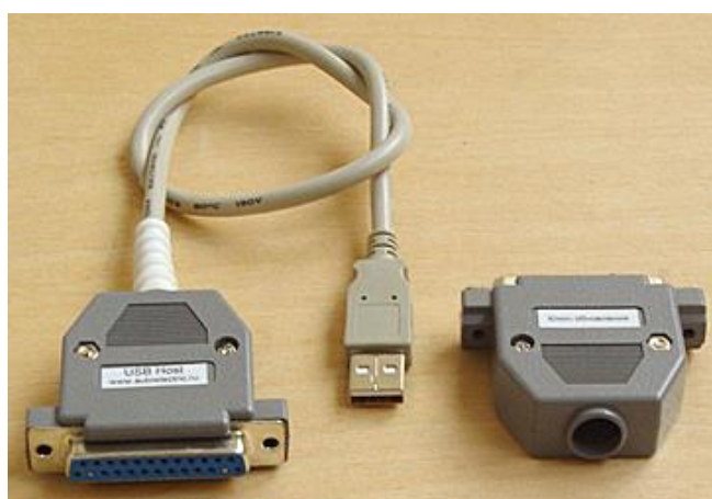
Рис. 5. Кабель для соединения адаптера с персональным компьютером
