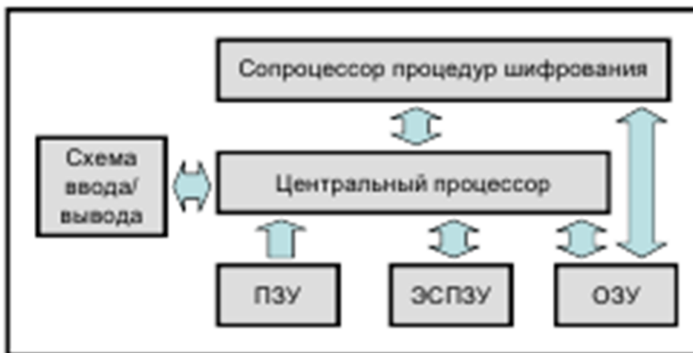
Рис. 4.2. Блок-схема смарт-карты с микропроцессором
