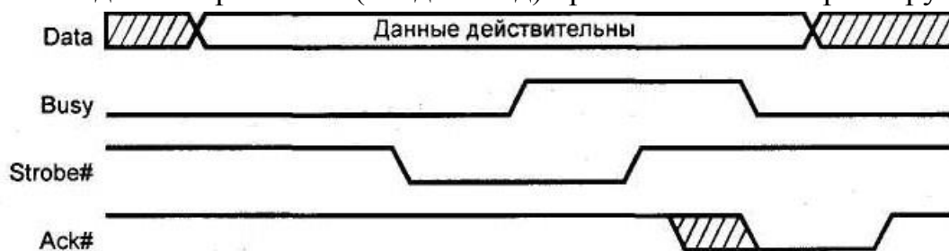
Рис. 3.1 – Передача данных по протоколу Centronics
