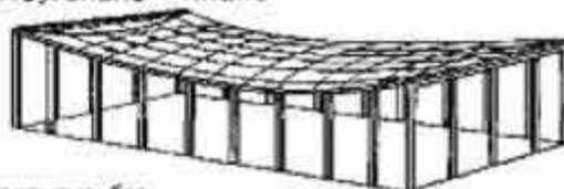
покрытие без оттяжек с шпренгельными сегментами
