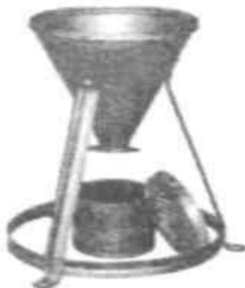
1 – корпус, 2 – трубка, 3 – задвижка, 4 – мерный цилиндр
