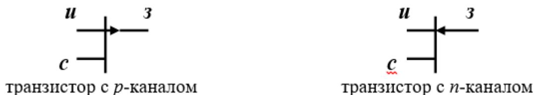
Рисунок 4.2 – Графическое изображение полевых транзисторов
