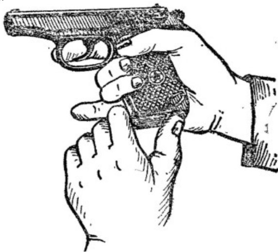
Рис. 3. Извлечение магазина из основания рукоятки
