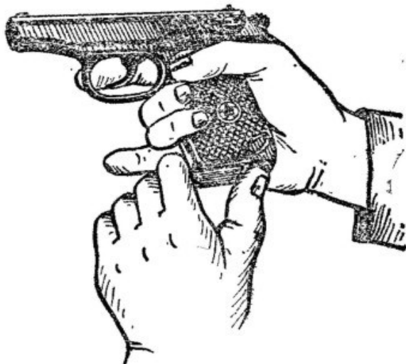
Рис. 3. Извлечение магазина из основания рукоятки
