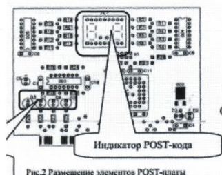
Рис.2 Размещение элементов POST-платы
