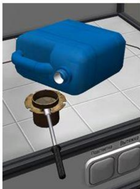
Рис. 4.3. Взятие образца топлива
