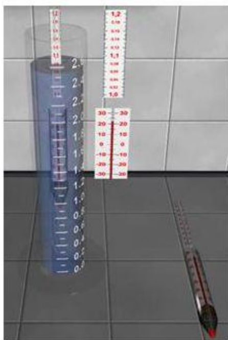
Рис. 3.4. Нефтеденсиметр в сосуде
