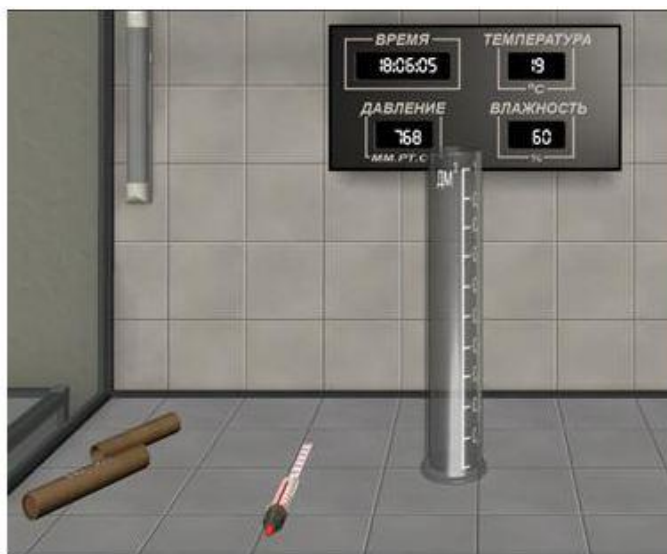
Рис. 3.3. Стеклоанная колба, нефтенденсиметр, мультитчасы
