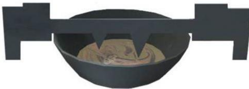
Рис. 4.1. Измерение уровня масла шаблоном
