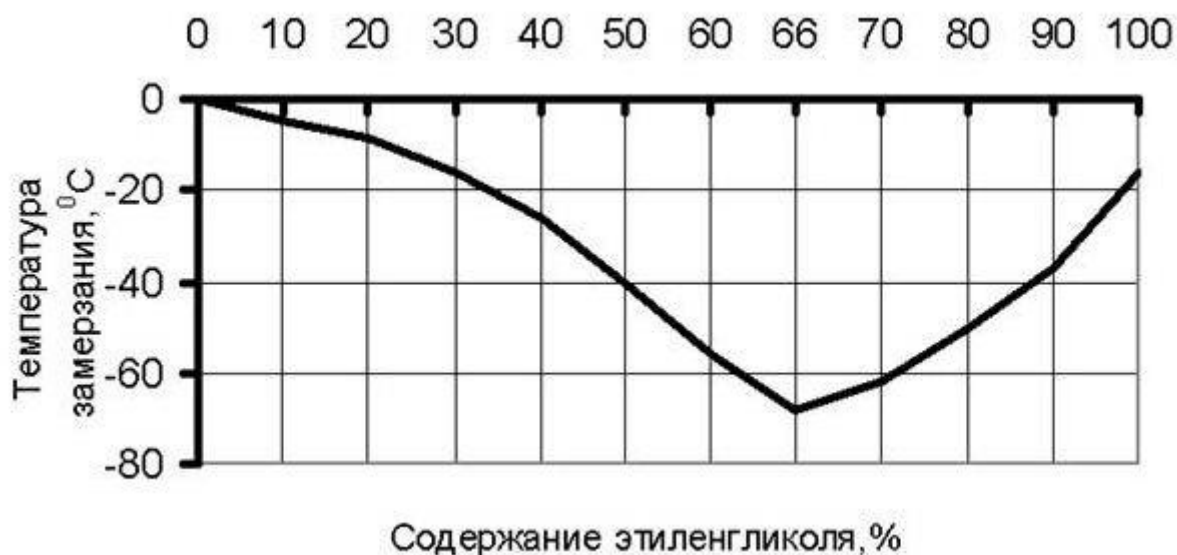
Рис. 2.1. Кривая кристаллизации водноэтиленгликолевых смесей
