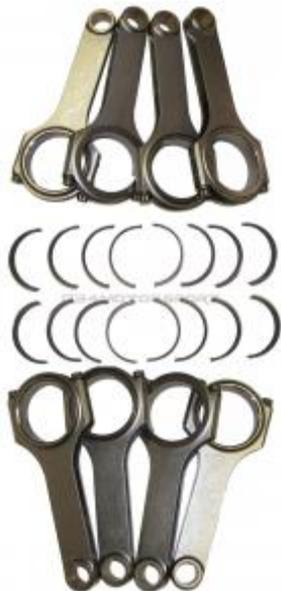
Шатун изготовлен из высококачественной стали и имеет форму, имеющую высокий коэффициент сопротивления изгибу и скручиванию. При помощи поршневого пальца шатун крепится к поршню. Коленчатый вал также изготовлен из высококачественной легированной стали.
