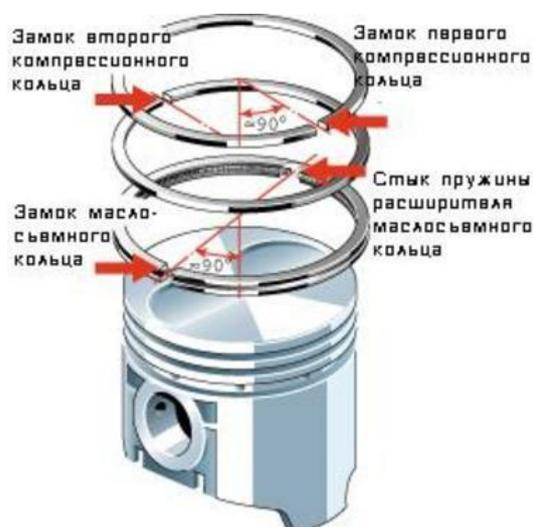
Выбор в пользу алюминиевого сплава в сравнении со стальными материалами очевиден: он гораздо легче, не уступает в жесткости и обладает более лучшим теплопроводом. Сопряжение между стенкой гильзы и юбкой поршня уплотняется при помощи компрессионных и масло-съемных колец, которые не позволяют горячим газам от сгорания топлива проникнуть под поршень в картер двигателя.
