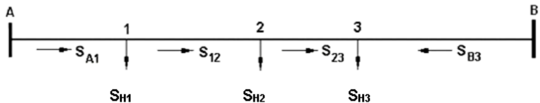
Рисунок 2.2 – Представление принципиальной схемы сети кольцевого типа сетью с двухсторонним питанием
