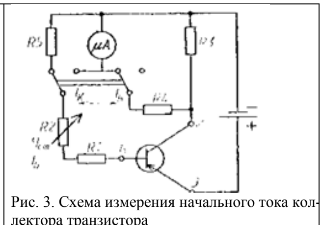
Рис. 3. Схема измерения начального тока коллектора транзистора
