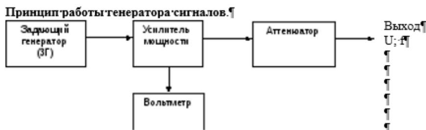
Рис. 3 Структурная схема генератора
