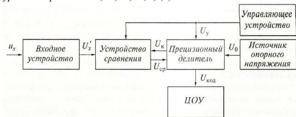
Рисунок 2. Структурная схема кодоимпульсного вольтметра
