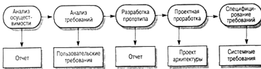
Рисунок 4.1 - Этапы процесса разработки спецификации
