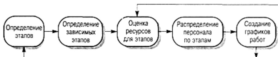
Рисунок 4.2 - Процесс составления графика работ
