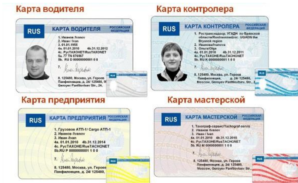
Рис. 6.3. Смарт карты для цифровых тахографов
