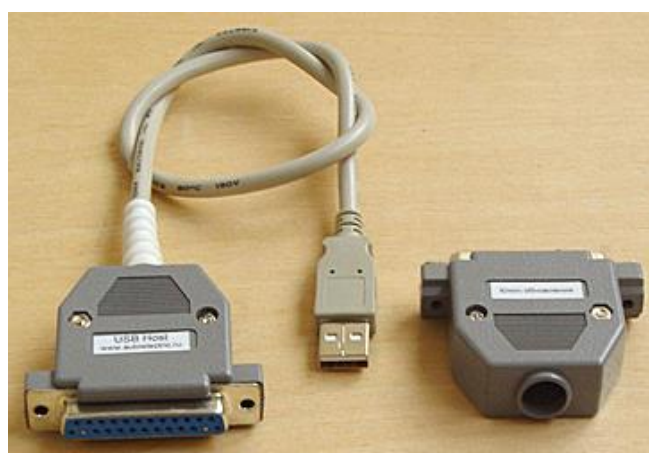
Рис. 5. Кабель для соединения адаптера с персональным компьютером
