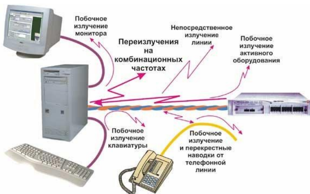
Рис 3.1 Основные источники возникновения ПЭМИ при работе СВТ
