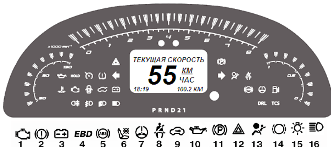
Рисунок 3 –Цифровой дисплей без стрелочных указателей одной из моделей ChevroletLacetti: 1 – Сигнализатор «Check-Engine»; 2 - Сигнализатор аварийного состояния рабочей тормозной системы; 3 - Сигнализатор разряда АКБ; 4 - Сигнализатор неисправности электронного распределения тормозных сил; 5 - Сигнализатор неисправности АБС; 6 - Сигнализатор отключения подушек безопасности переднего пассажира; 7 - Сигнализатор электроусилителя руля; 8 - Сигнализатор не пристёгнутых ремней безопасности; 9 - Сигнализатор системы иммобилизера; 10 - Сигнализатор аварийного давления масла; 11 - Сигнализатор стояночного тормоза; 12 –Аварийка; 13 - Сигнализатор подушки безопасности; 14 – Сигнализатор износа тормозных колодок; 15 - Сигнализатор включения наружного освещения; 16 - Сигнализатор дальнего света фар.
