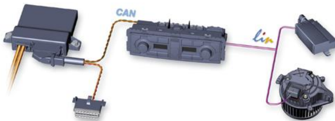
Рисунок 5 – Структурная схема взаимодействия различных цифровых автомобильных шин данных
