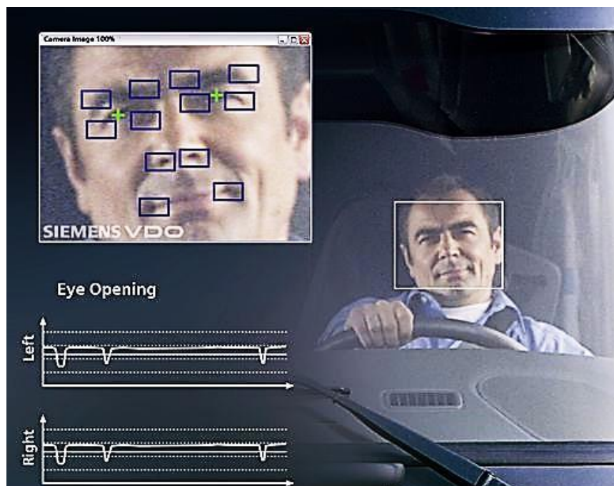
Рисунок 14 – Система видеоконтроля усталости водителя на основе анализа поведения глаз.
