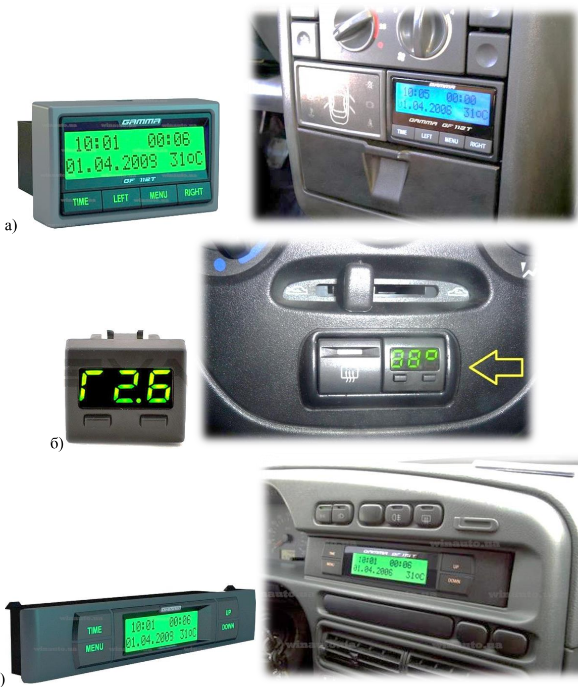
Рисунок 2 – Внешний вид автомобильных маршрутных компьютеров разного типа исполнения, автомобилей российского производства:
