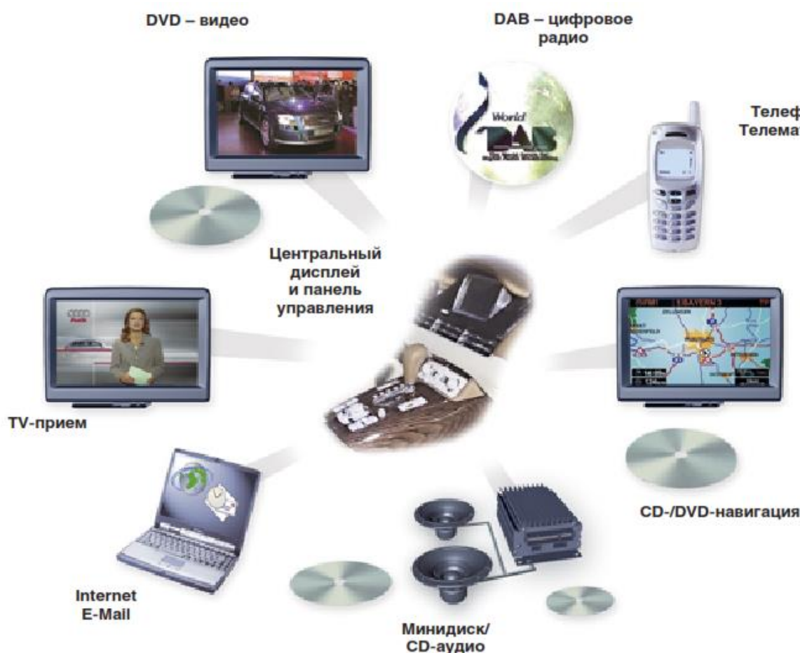
Рисунок 6 – Взаимодействие систем автомобиля по шине MOST.
