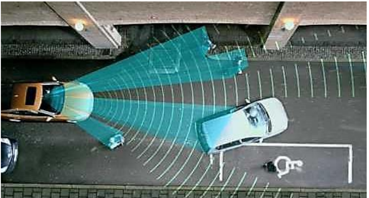
Рисунок 9 – Принцип обнаружения пешеходов и автомобилей с помощью видеокамеры и радара.
