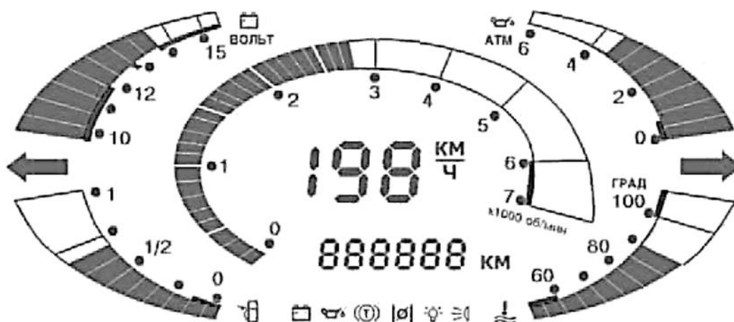
Рисунок 4 - Светодиодная электронная приборная панель одной из моделей автомобилей японского производства
