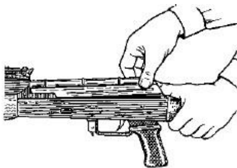
Рис. 13. Отделение крышки ствольной коробки
