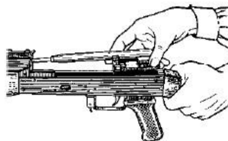
Рис. 15. Отделение затворной рамы с затвором
