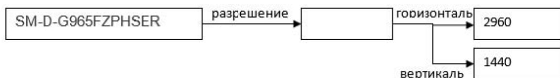
Рис. 1 Граф, описывающий разрешение дисплея
