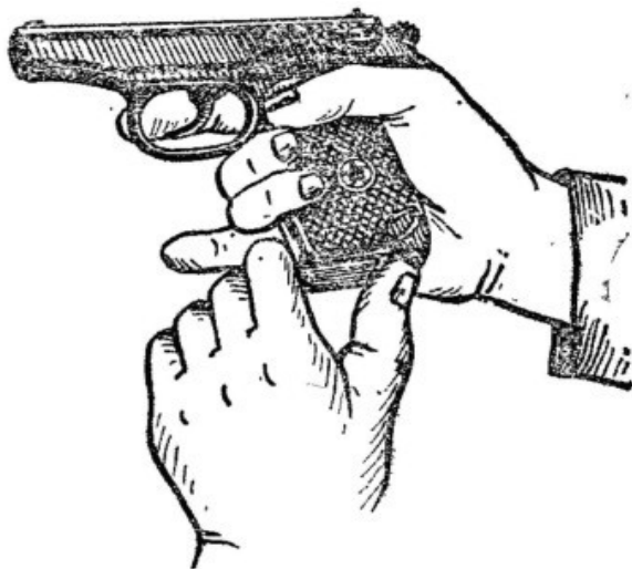
Рис. 3. Извлечение магазина из основания рукоятки
