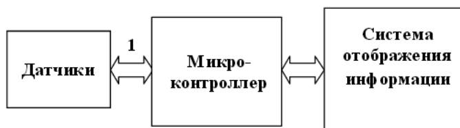
Рис. 4. Структура автономной контрольно-измерительной системы.
