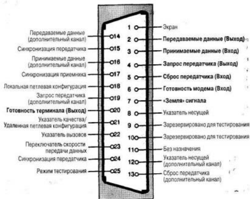
Рисунок 3.- Назначение контактов Сом порта.
