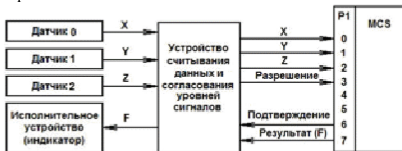
Рис. 26.1. Структурная схема микропроцессорной системы обработки битовой информации
