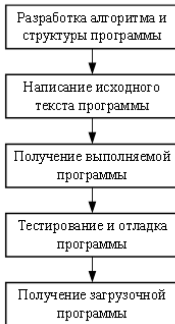
Рис. 5. Последовательность разработки ПО для микроконтроллеров
