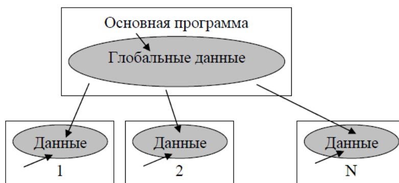
Рисунок 1.4 - Принцип работы программы, использующей подпрограммы с локальными данными
