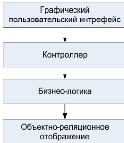
Рисунок 6.1 - Трехслойная архитектура с контроллером
