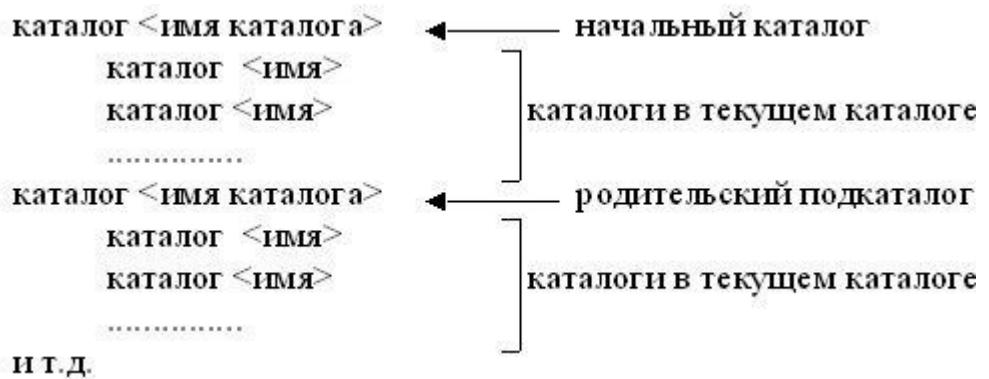
3. Shell-программа подсчитывает количество и выводит перечень каталогов в хронологическом порядке (по дате создания) в поддереве, начиная с каталога, имя которого задано параметром Shell-программы. Форма вывода результата:
