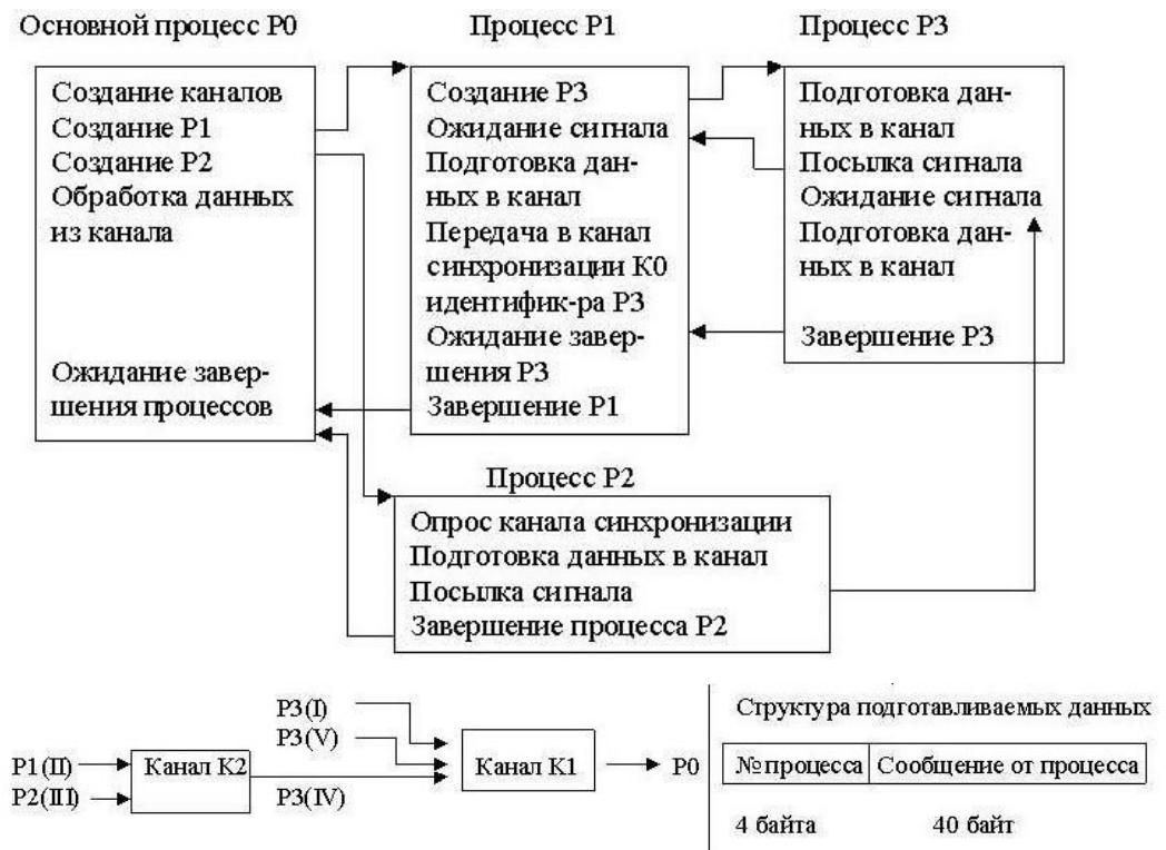
Обработка данных основным процессом заключается в чтении информации из программного канала K1 и записи её. Кроме того, посредством выдачи сообщений необходимо информировать обо всех этапах работы программы (создание процесса, завершение посылки данных в канал и т.д.).
