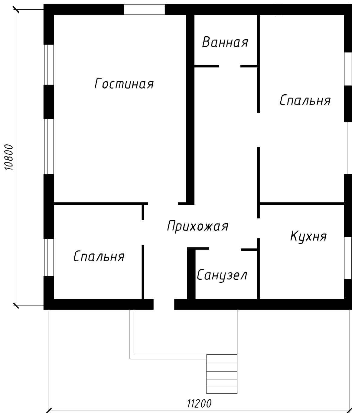
Рис. 8.4. Одноэтажный одноквартирный трехкомнатный жилой дом (вариант 2)
