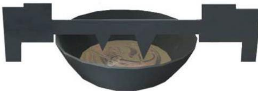
Рис. 4.1. Измерение уровня масла шаблоном
