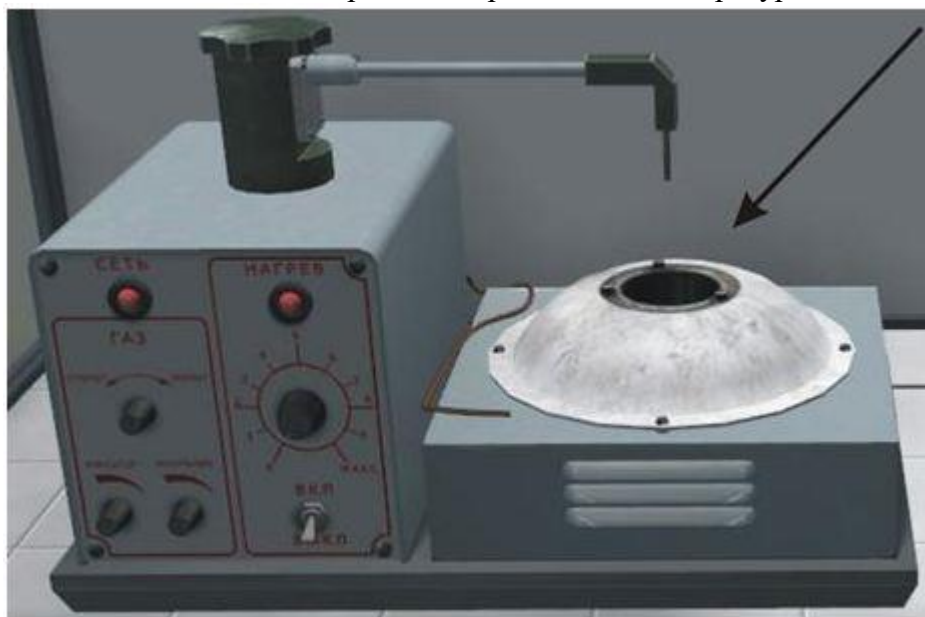
Рис. 4.4. Аппарат для определения температуры вспышки
