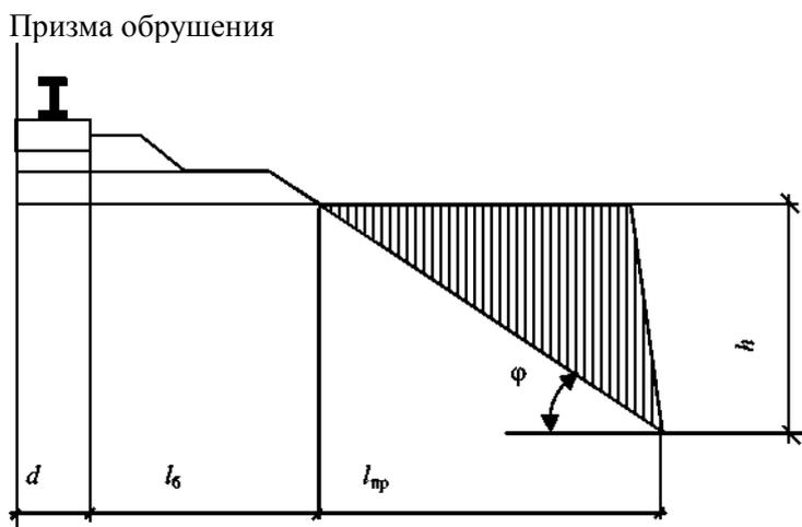
Рис. Расчетная схема расположения подкранового пути при открытом котловане
