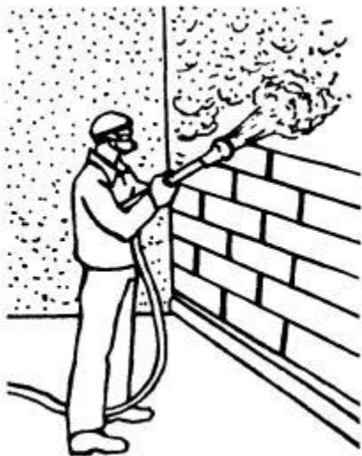
Рисунок 5 - Последовательное нанесение слоев обрызга, грунта
