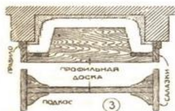
ШАБЛОН ДЛЯ ТЯГИ КЕССОНА (ПО ДВУМ БАЛКАМ)
