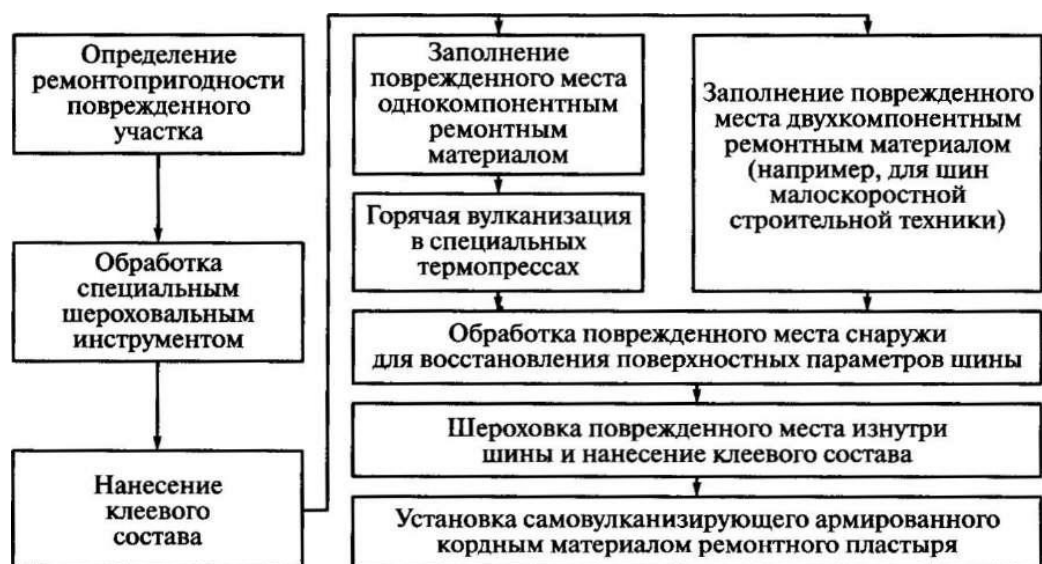
Рис. 6.8. Основные этапы ремонта сквозных повреждений шин
