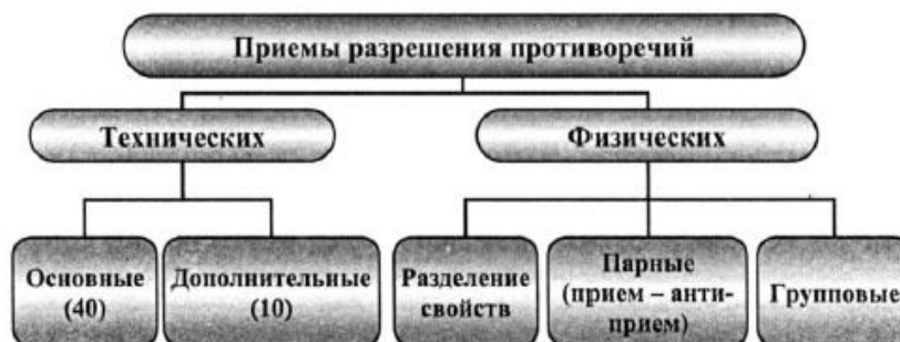
Рис. 1. Схема приемов разрешения противоречий
