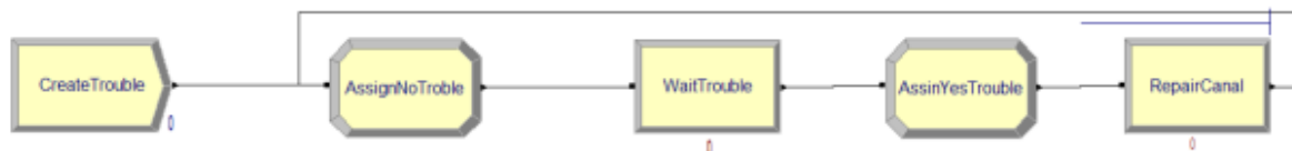
Рисунок 13.3 – Схема моделирования сбоя в канале связи
