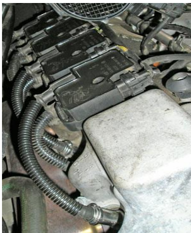
Рис. 17. Индивидуальное двойное дистанционное зажигание.
