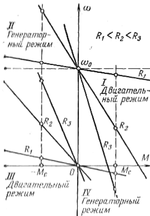
Рис. 4.6. Механические характеристики двигателя постоянного тока независимого возбуждения при различных режимах работы.
