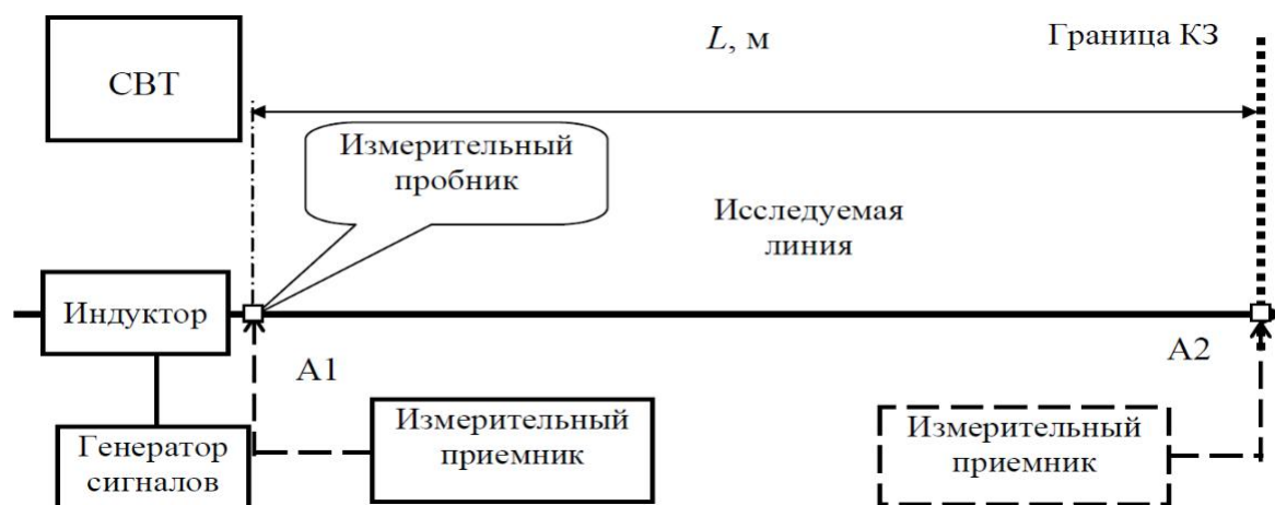
Рисунок 1 - Схема измерения реального затухания в линии
