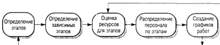
Рисунок 4.2 - Процесс составления графика работ
