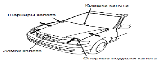
Рис. 4.1. Общий вид капота и точек регулировки
