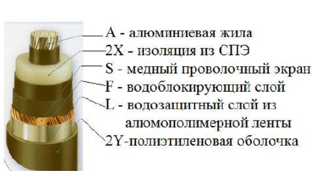
Рисунок 6.18 – Элементы конструкции кабелей с СПЭ изоляцией с алюминиевой A2XS(FL)2Y или с медной жилой 2XS(FL)2Y в пластмассовой оболочке
