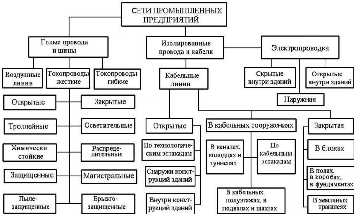
Рисунок 2.4 – Классификация электрических сетей по конструктивным признакам
