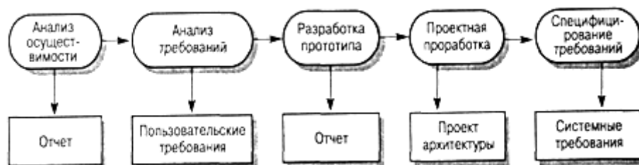
Рисунок 3.1 - Этапы процесса разработки спецификации
