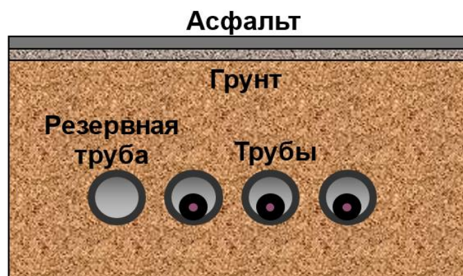
Рисунок 28 – Прокладка кабелей в каналах
