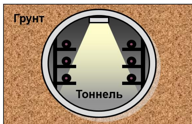
Рисунок 29 – Прокладка кабелей в туннеле
