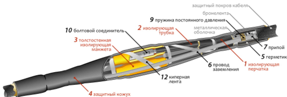
Рисунок 33 - Термоусаживаемая кабельная муфта
