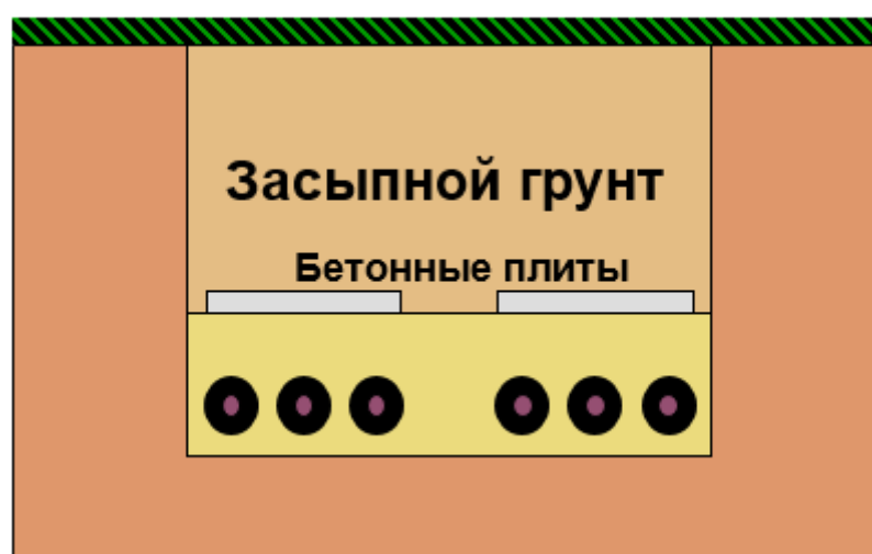
Рисунок 27 – Прокладка кабелей в траншее
