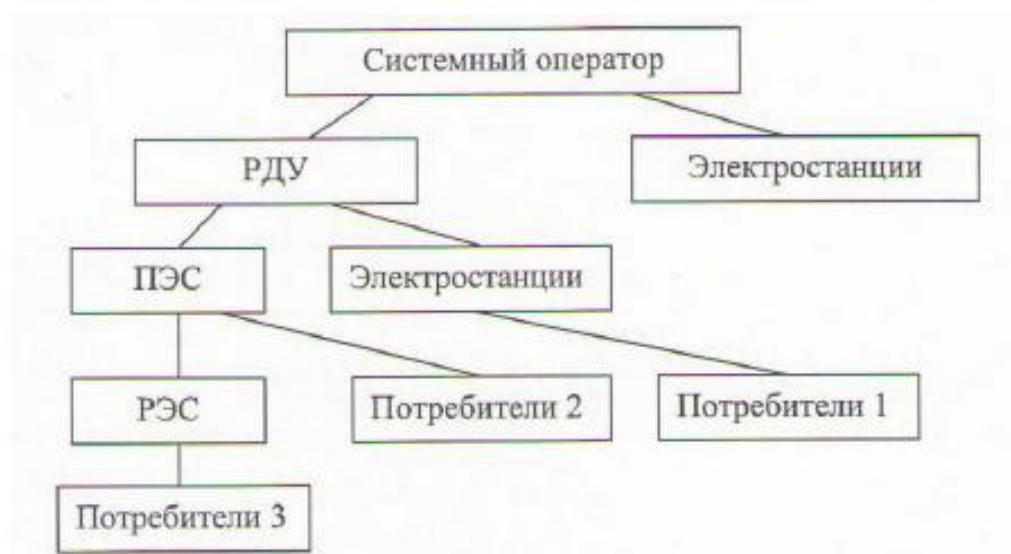
Рисунок 1. Схема оперативно-диспетчерского управления в электроэнергетике
