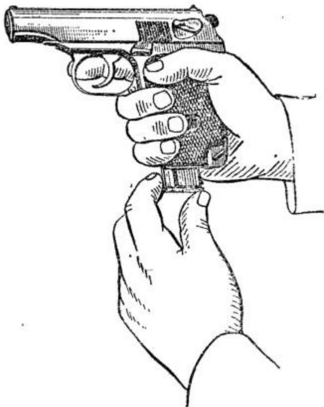
Рис. 8. Вставление магазина в основание рукоятки
