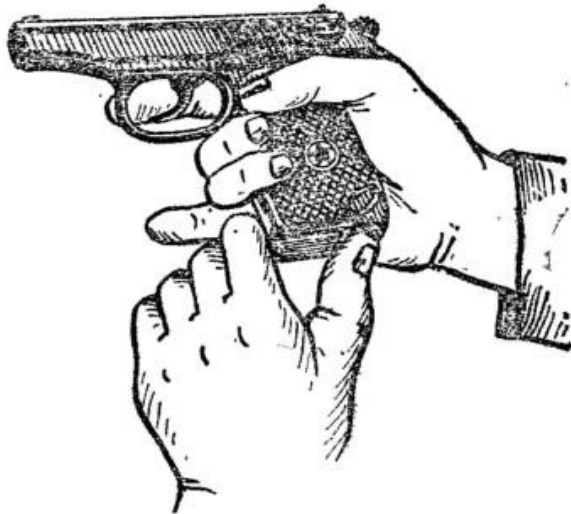
Рис. 3. Извлечение магазина из основания рукоятки
