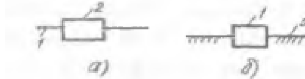
Рисунок 1.2 – Поступательные кинематические пары 5-го класса
